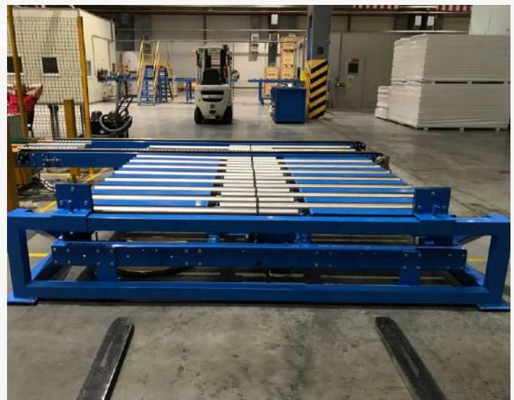
Накопительный конвейер поддонов **существенно ускоряет процесс транспортировки** готовой продукции, за счет уменьшения количества рейсов автопогрузчика.
