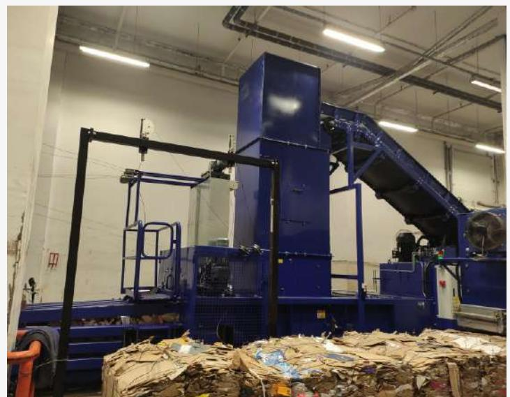
**Подающий Z-образный конвейер** – обеспечивает загрузку автоматических горизонтальных прессов.
