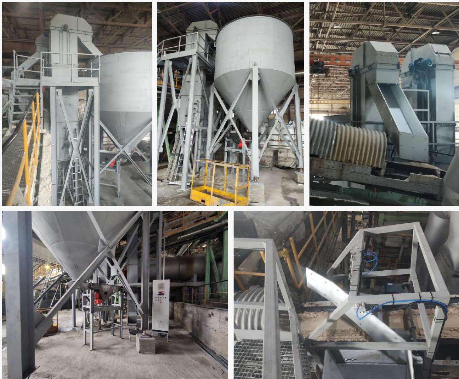
**Назначение системы** — обеспечение постоянной, равномерной и управляемой подачи продукта в сушильный барабан.
